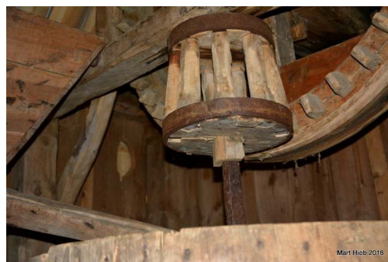
Foto 186. Ranna kordatehtud tuuliku tala aastaarvuga ja jahvatamismehhanism. Fotod Mart Hiob 2016.
